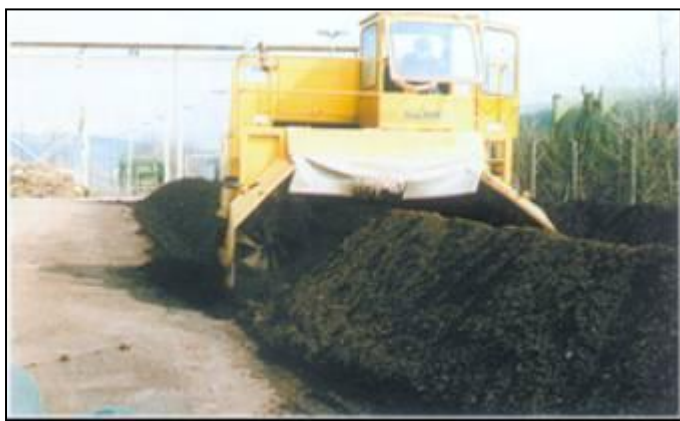
Figura16: Sistem de compostare cu grămezi cu întoarcere
